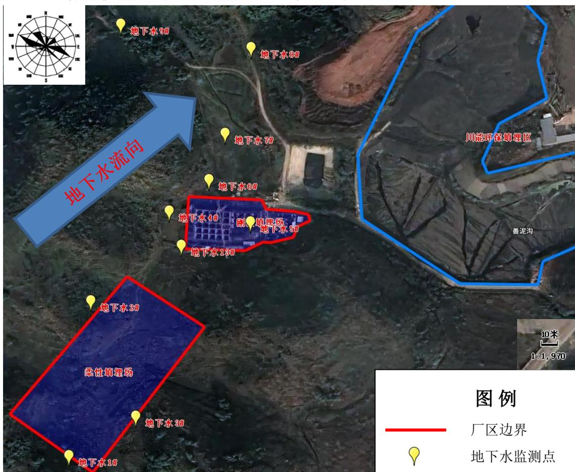
图 7-1 柔性填埋场地下水监测点位示意图
