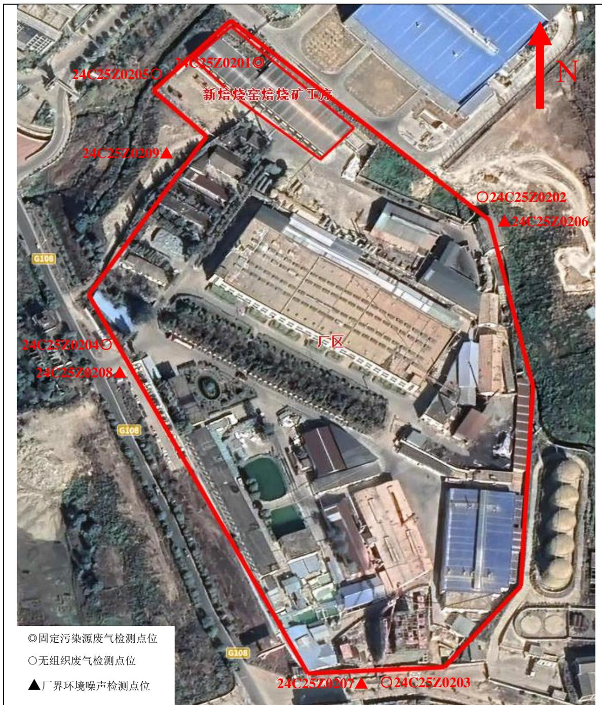
图 6-1 项目监测点位布置示意图
