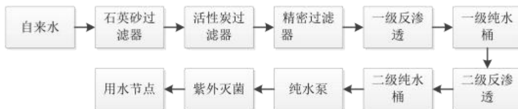
图 2-21 纯水制备工艺流程图
