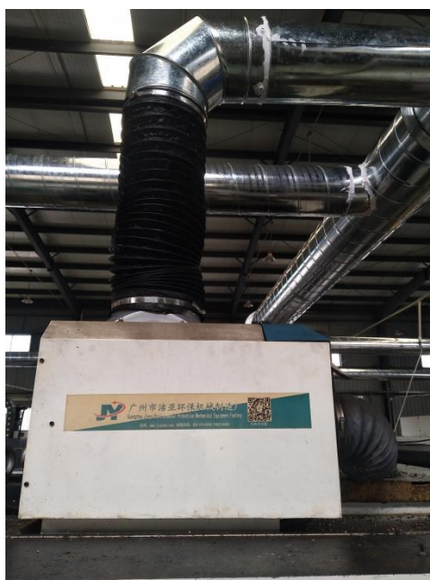
图 3-2 机床顶部自带油雾吸附器
